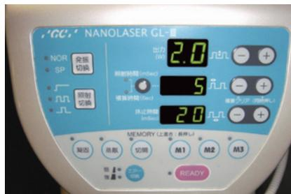
8-1 「ナノレーザー GL-III」の操作パネル。必要な出力形態がメモリーしておくことで、マニュアルを読む必要なく、簡単に操作内容を選択できる。
